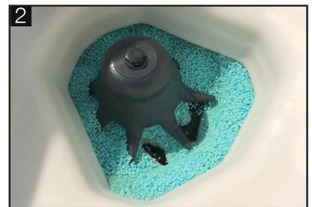
O agitador regula o fornecimento e promove o fluxo de fertilizantes. Girando a 17 rpm, reduz os danos e impede a formação de pó
