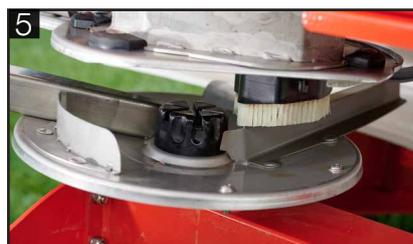
Escova condutora garante o fluxo do produto até as palhetas. Defletores reduzem a turbulência para garantir um fluxo uniforme
